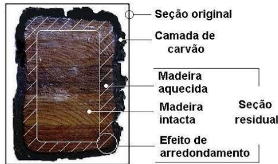
Figura 2.3 - Secção transversal da carbonização da madeira [10].
