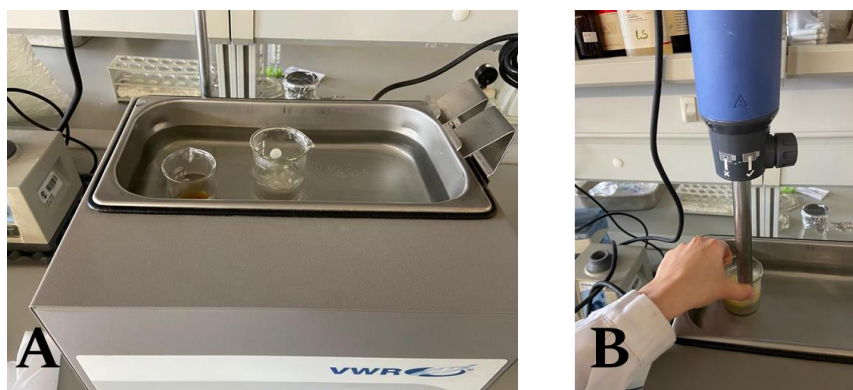
Figura A.4.1. Equipamento utilizado para a produção dos cremes de rosto. A - Banho termostático; B – Homogeneização das duas fases do creme, com auxílio do homogeneizador de alta performance.
