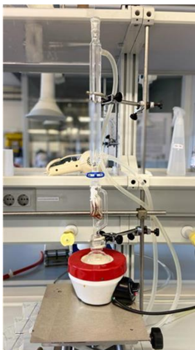
Figura A 2.1. Montagem da extração sólido-líquido pelo método Soxhlet, para a obtenção do extrato fenólico e do óleo grainha de uva. A principal diferença foi o solvente usado.
