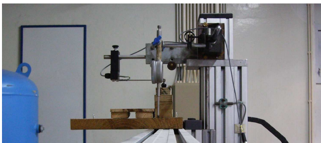
Figura 22. Dispositivo de calibração dos cabos de amarração e das defensas: calibração de uma defesa.
