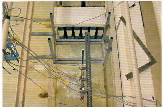
Figura 8. Modelo físico do cais com 0,5 m de desenvolvimento.
