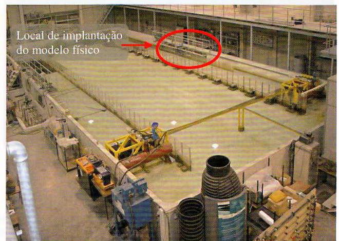
Figura 5. Tanque de ondas do LH-FEUP à data de realização dos ensaios em modelo físico.
