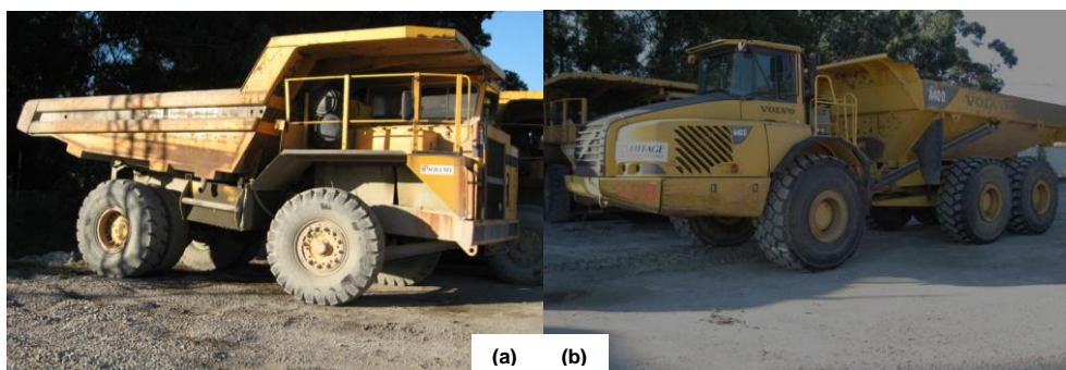
Figura 1: a) Dumper Euclid R 32 (modelo antigo) b) Dumper Volvo A 40 (modelo novo)
