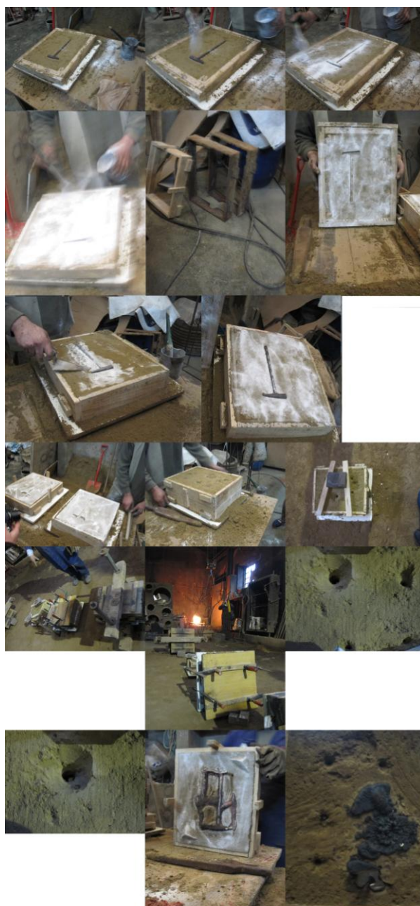
Fig. 9 - Processo de moldagem e fundição "caixa de areia Lisboa", processo de fundição realizado em Gulpilhares. Janeiro de 2010. Imagens posteriormente editadas e impressas com meio digitais. MH. Póvoa de Varzim, Abril 2010.
