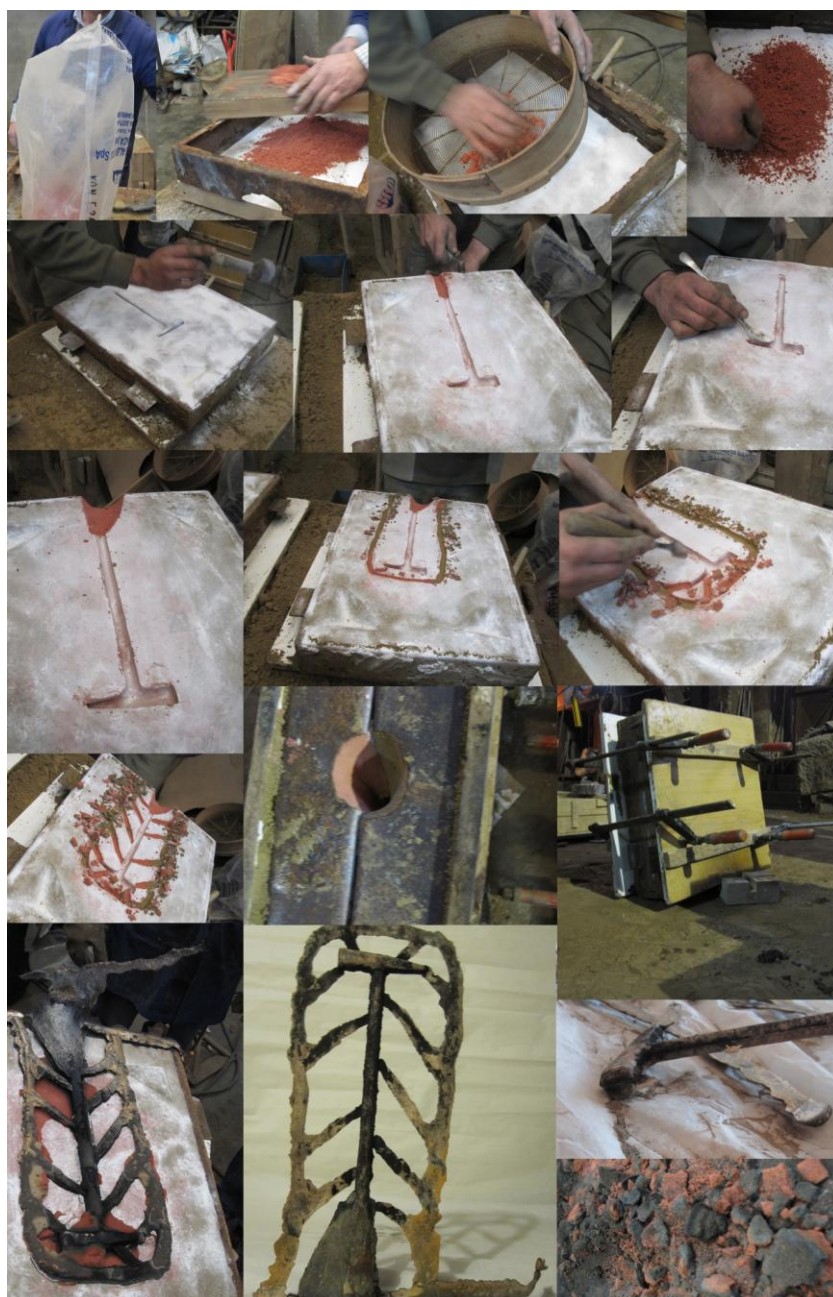
Fig. 10 - Processo de moldagem e fundição em caixa de areia “vermelha”, um tipo de areia mais fino, permite mais detalhe da superfície do objecto matriz. Fundição em Gulpilhares, Janeiro de 2010. Imagens editadas e impressas com meios digitais. Póvoa de Varzim, Março de 2010. MH.
