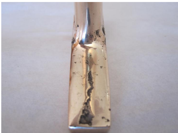
Fig. 13 - Martelo editado pelo processo de moldagem e fundição em caixa de areia “vermelha”. No processo de limpeza e polimento foi mantida a marca resultante do processo de fundição, marca existente numa parte menos visível da cabeça do martelo editado. Março de 2010. Póvoa de Varzim. MH.
