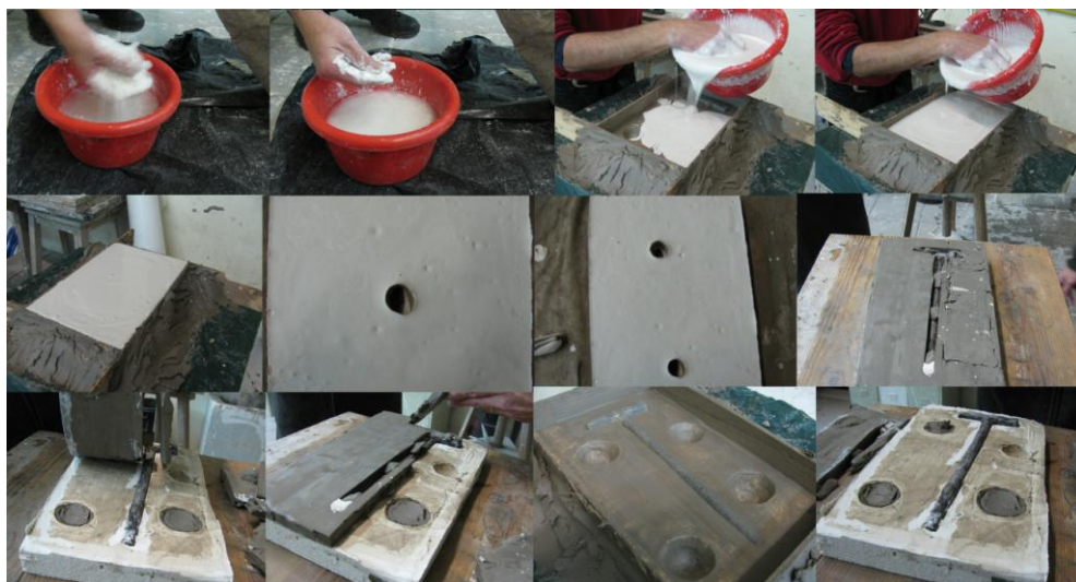
Fig. 11 - Execução de molde em gesso do martelo já feito. Molde utilizado para a edição do protótipo em cera para o processo de fundição por cera perdida e para a edição de réplicas do objecto matriz em pasta cerâmica refractária. Pavilhão de Escultura , FBAUP Janeiro de 2010. Porto. Imagens captadas por Professor Dr.º Fernando Amaral da Cunha. Imagens editadas e organizadas com programa de edição de imagem digital. Junho de 2010. Póvoa de Varzim. MH.
