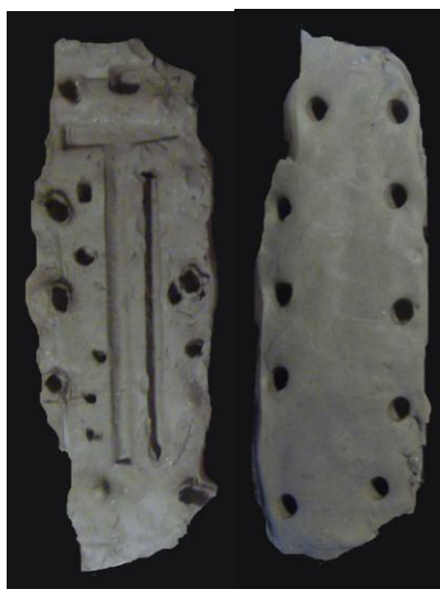
Fig. 6 - Molde rudimentar , imagem do objecto processual. Molde em barro utilizado para reproduzir elementos em silicone termo fusível. Novembro de 2009. Póvoa de Varzim. MH.
