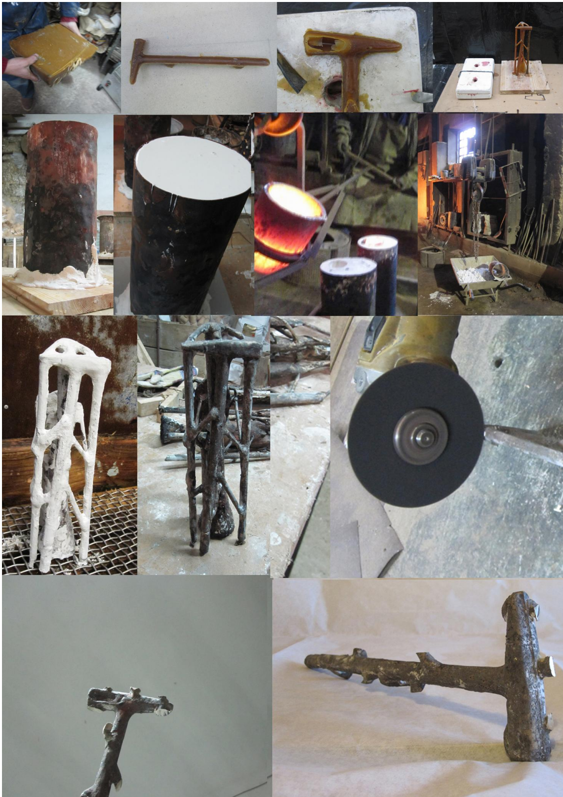
Fig. 12 - Processo de moldagem e fundição por cera perdida, protótipo em cera para fundição, árvore de fundição, molde cilíndrico em metal com gesso refractário, vazamento do metal, extracção do elemento em bronze do interior do núcleo molde em gesso (molde perdido), limpeza da capa de fundição e retirar o martelo produzido da árvore de fundição. Gulpilhares, Fevereiro de 2010. Imagens editadas e impressas com meio digitais. Março de 2010. Póvoa de Varzim. MH.
