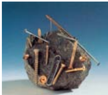
3.2 A magnetite é um mineral que, no estado natural, tem a propriedade de atrair o ferro e o aço.
