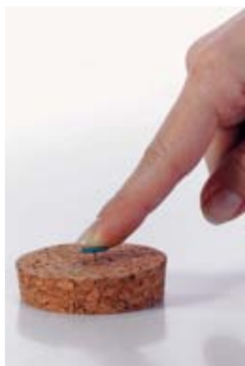
4.4 Para uma mesma força, a pressão é tanto maior quanto menor for a área da superfície sobre a qual a força actua.
