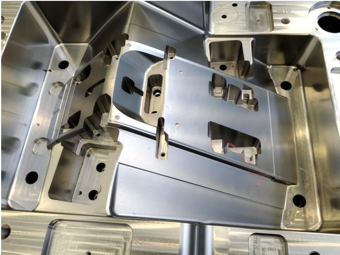
Figura 10 - Bloco principal de um molde, exemplo de maquinações de acabamento e '2D'
