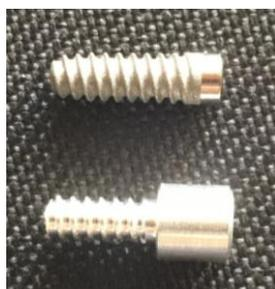
Fig. 29- Simulação de roscas, forma e dimensão de um implante numa amostra de alumínio 6061.
