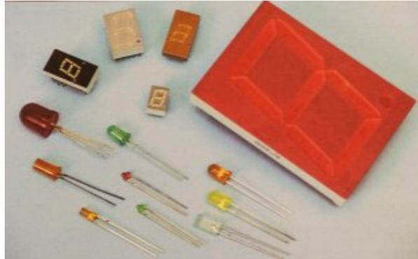
**Figura 7:** Vários tipos diferentes de LED. Cada algarismo num display numérico está formado por 8 LEDs.
