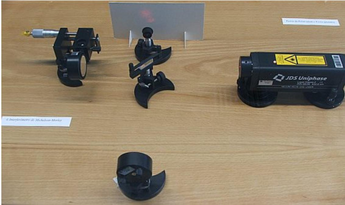
**Figura 3:** O interferómetro de Michelson permite detectar diferenças entre os percursos da luz em duas direcções perpendiculares.
