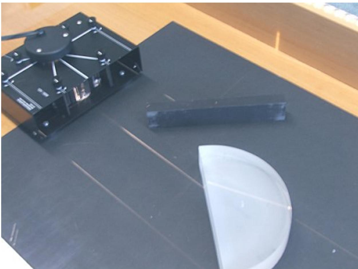
Quando colocamos uma barreira com uma fenda em frente de uma fonte de luz, unicamente os raios de luz que passam pela fonte e pela fenda conseguem ultrapassar a barreira. É assim que se consegue produzir um feixe de luz fino.
