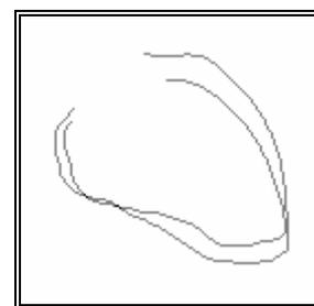
Figura 324 - Contornos 1 e 2 com os *pixels* ligados por segmentos de recta.
