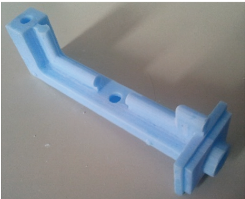
Figura 5 – Modelo em cera obtido por impressão 3D de cera.
