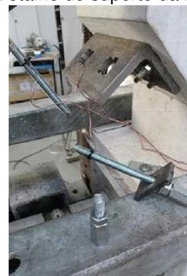
d) Detalhe da falha da barra
