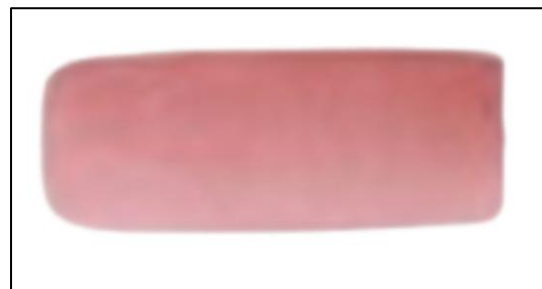
Figura 2. Desenho do provete de resina em stl (8x3mm). Imagem de autoria própria.
