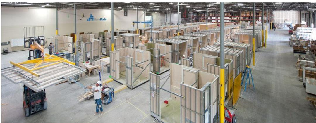
Figura 7 - Pré-fabricação de casas de banho [16]
