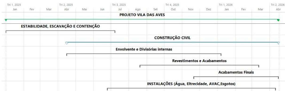
Figura 31 – Diagrama de Gantt retirado do Microsoft Project de sequência dos grupos de tarefas da obra
