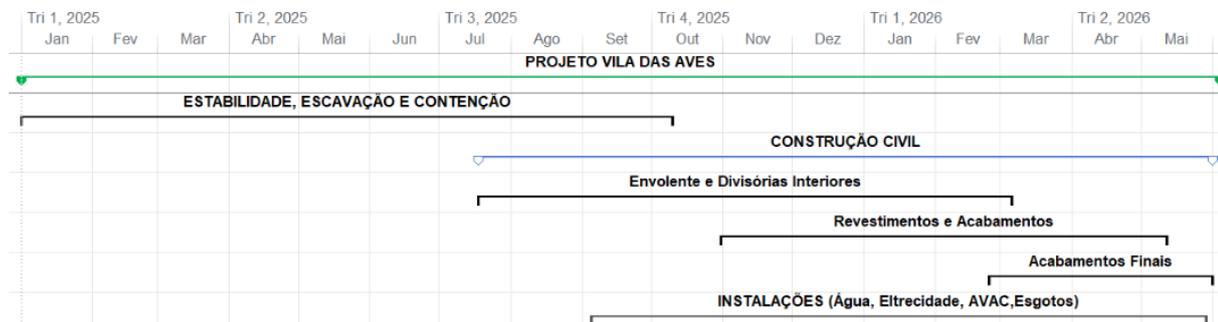
Figura 43 - Esquema retirado do *Microsoft Project* de seqüência dos grupos de tarefas da obra para solução em Betão armado com casas de banho pré-fabricadas
