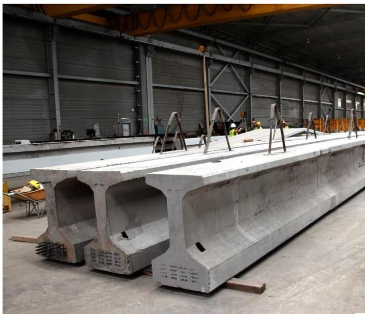
Figura 5 - Vigas de Betão armado pré-fabricadas [13]
