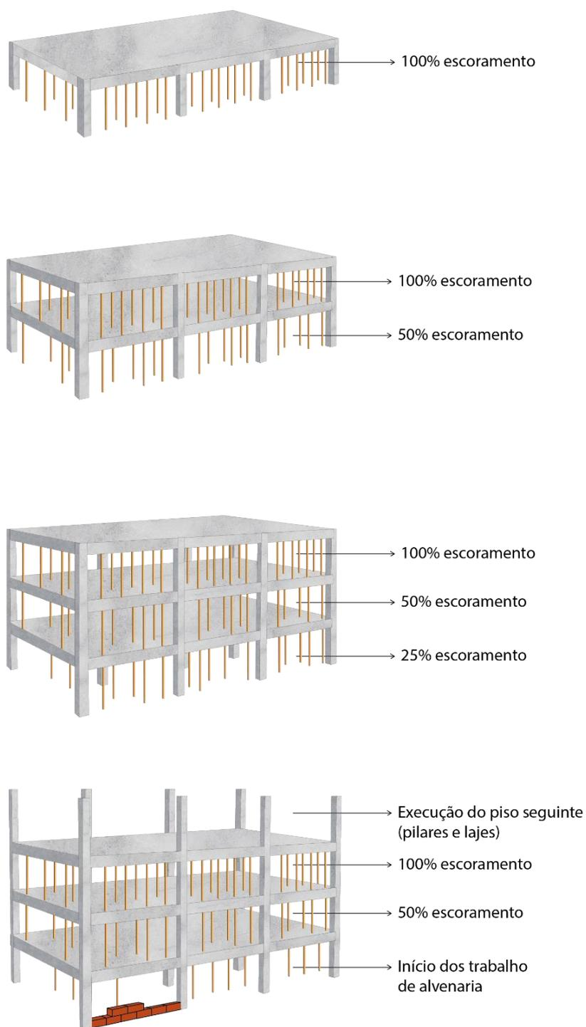
Figura 36 - Esquema do processo de realização da estrutura em betão armado e começo dos trabalhos de alvenaria
