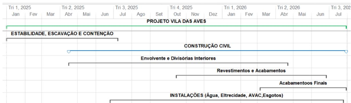
Figura 42 - Esquema retirado do *Microsoft Project* de sequência dos grupos de tarefas da obra para solução em estrutura metálica com casas de banho feitas *in loco*
