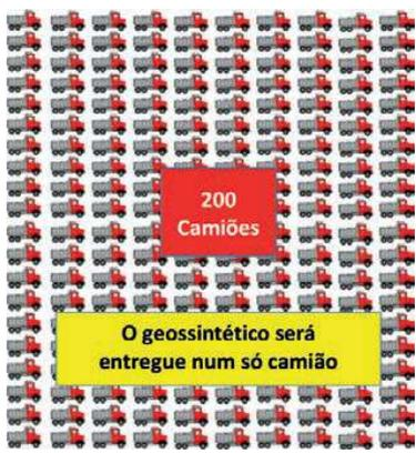
Figura 7. Poupança em termos de transporte de materiais para camada de base de uma estrada com 5 m de largura, por km de comprimento (adaptado de [10]).
