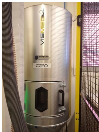
Figura 2. Estufa utilizada para acondicionar o filamento antes da impressão.
