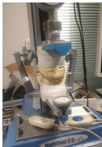
Figura 20. Aplicação de carga na goteira com sensores de pressão incorporados.
