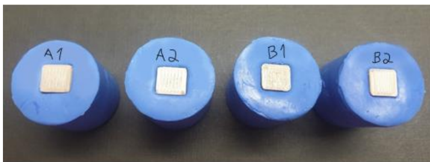
Figura 7. Acondicionamento dos provetes no suporte em silicone de adição para realização do polimento dos mesmos.
