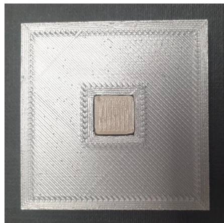
Figura 6. Suporte para fixação dos provetes para leitura da topografia de superfície.
