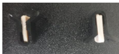
Figura 11. Provetes inseridos nos clips de fixação para posterior montagem em resina epóxi.
