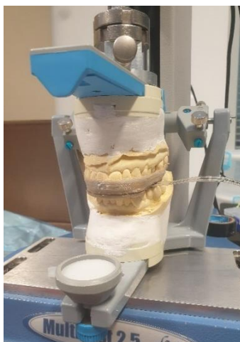
Figura 26. Testes de carga com a goteira impressa em PEEK em duas partes, adaptada nos modelos montados em articulador.
