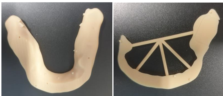
Figura 22. Goteira impressa em resina em duas partes, com sistema de encaixe "macho/fêmea".
