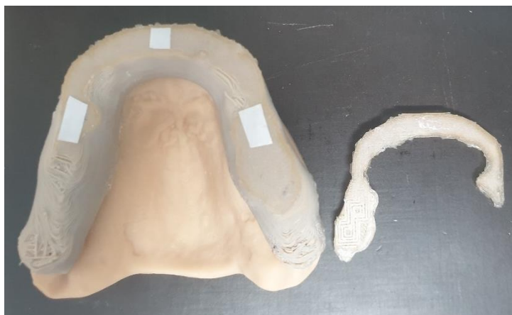
Figura 24. Goteira impressa em PEEK em duas partes com fita cola de dupla face para promover a união.
