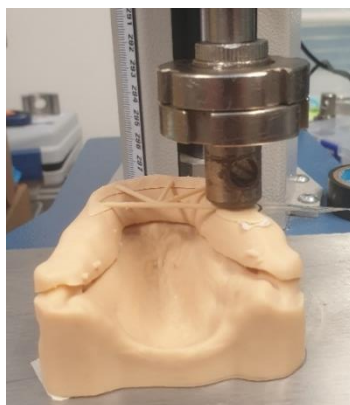
Figura 23. Testes de carga realizados na goteira impressa em resina.
