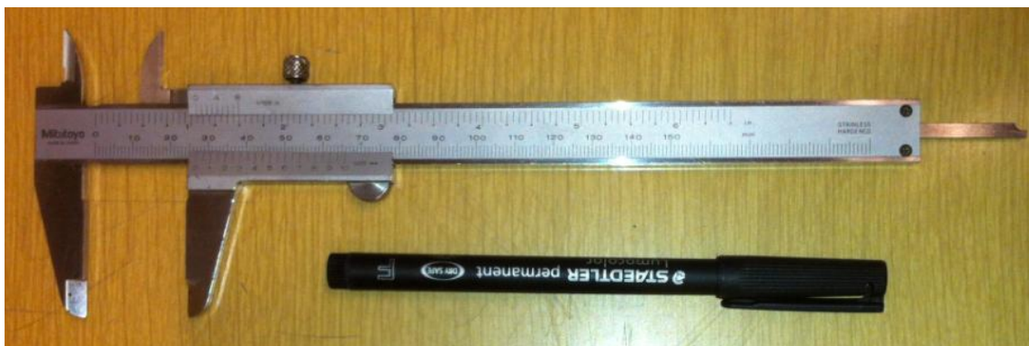
Figura V.3. 12. Paquímetro (Mitutoyo) usada para a medição do comprimento e diâmetro de cada cilindro (DGAOT, FCUP).
