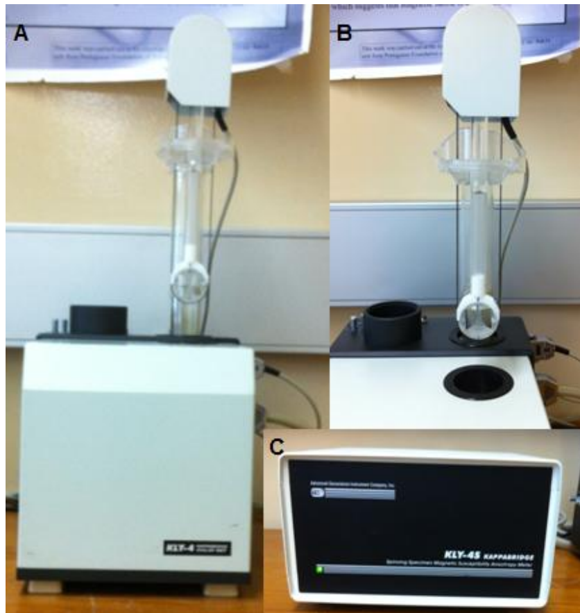
Figura V.3. 14. Equipamento de medição da ASM. A: local onde a amostra é sujeita a um campo magnético (H); B: amostrador (vista de cima); C: fonte de alimentação do aparelho de medição de ASM, Kappabridge KLY-4S do Departamento de Geologia, FCUP.
