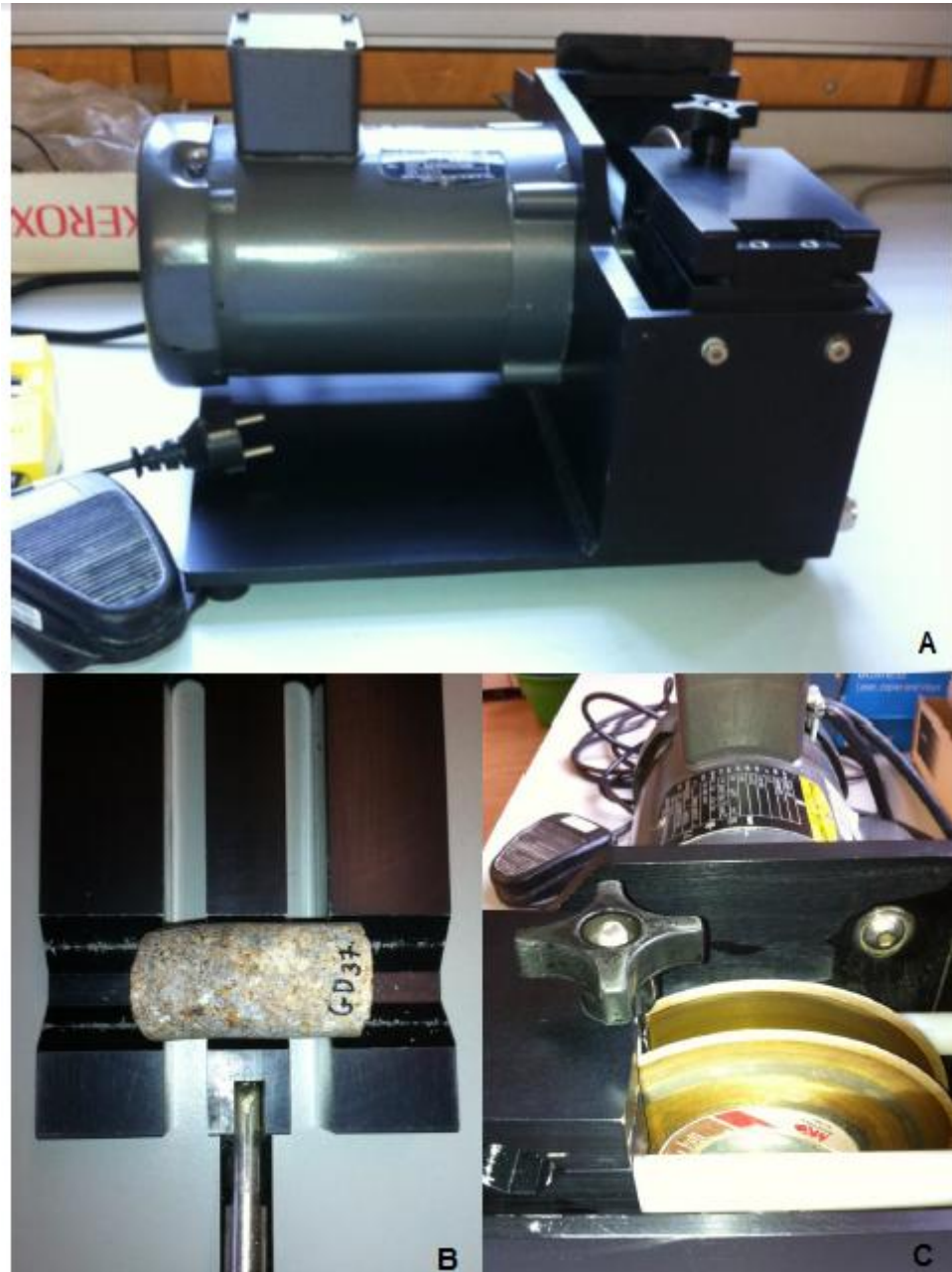
Figura V.3. 11. A: Aparelho de corte das amostras ( Baldor Reliancer industrial motor VL3501-50 ); B: Fixador do carote para posterior corte, com dimensões standard (2,5 cm de diâmetro e 2 cm de comprimento); C: Serra elétrica instalada no interior do aparelho de corte. Equipamento disponibilizado no Laboratório de Geologia do DGAOT (FCUP).
