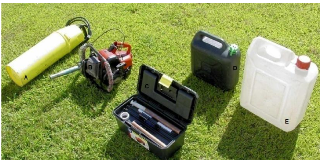
Figura V.3. 7. Material utilizado para a amostragem elaborada na área em estudo; A: Bomba de água para refrigeração da sonda mecânica; B: Sonda mecânica com broca de ponta diamantada; C: Ferramentas utilizadas para a manutenção da sonda; D: Combustível; E: Água para refrigerar a sonda mecânica.
