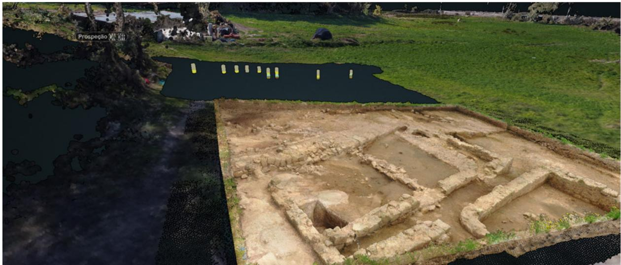
Figura 5 - Representação tridimensional georreferenciada dos logs dos ensaios de trado manual (CloudCompare v.2.12).
