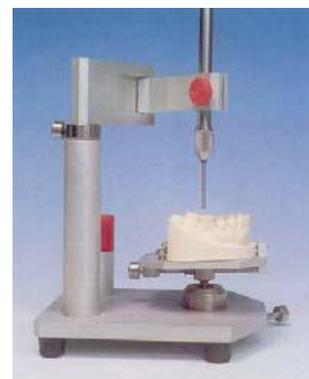
Fig. 9 – Paralelómetro.
