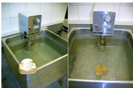
Fig. 156 – Banho em água a 42°C, para evitar um choque térmico com o contacto com a gelatina, mas sobretudo para a libertação de todas as bolhas de ar do modelo (quando se libertariam no silicone e prejudicariam a duplicação do modelo).
