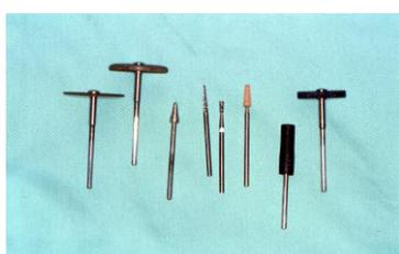
Fig. 164 – Instrumentos rotativos usados no polimento do esqueleto.
