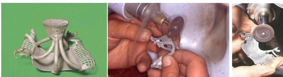
Fig. 163 – Corte dos canais de alimentação.
