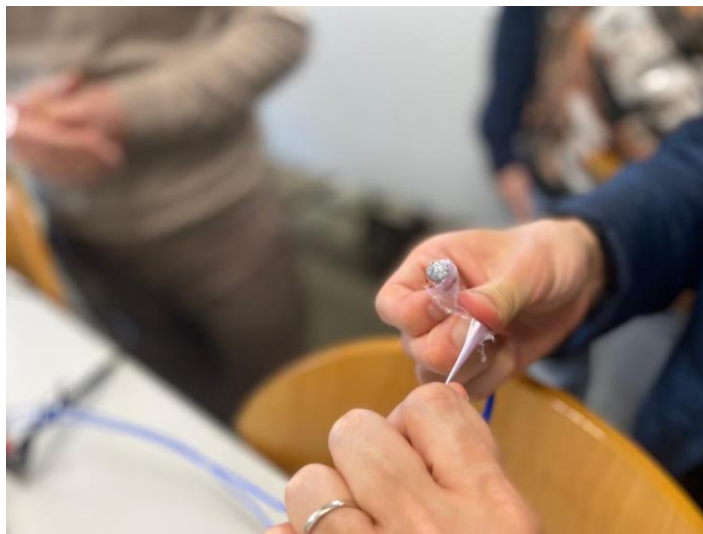
Figura 25: Recobrimento da antena com película isoladora
