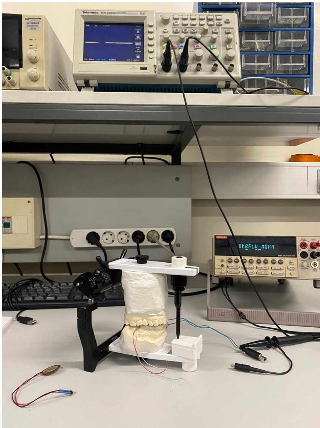
Figura 12: O sistema de Modelos de Gesso montados em articulador + sensor + multímetro
