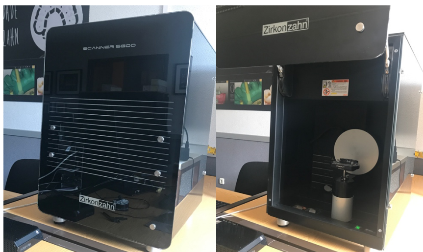
Figura 15 - Scanner laboratorial (S600 Arti, Zirkonzahn®, Itália) para digitalização dos esqueletos protéticos.
