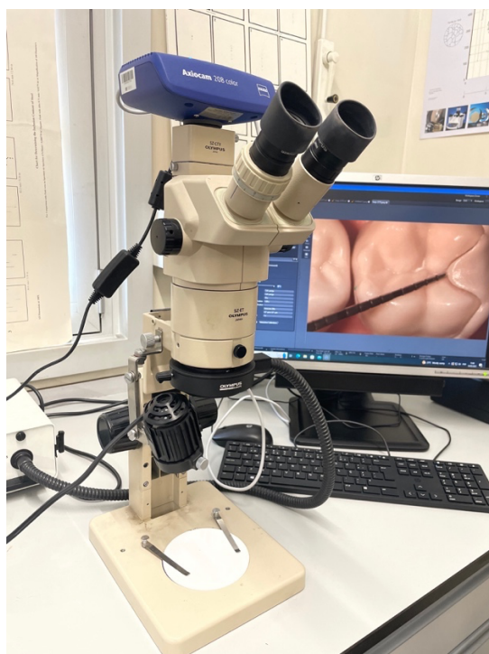
Figura 14 - Instrumentos de amplificação de imagem – Microscópio estereoscópico ( Olympus SZ-ET, Olympus® , Japão).
