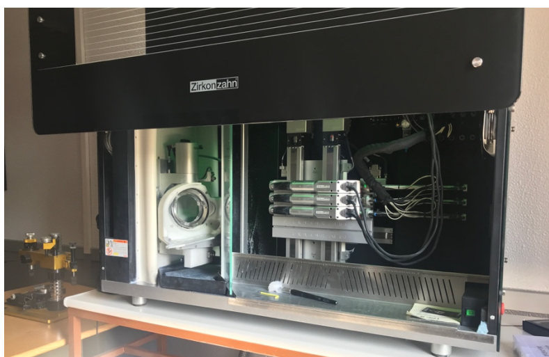
Figura 7 - Fresadora (M5, Zirkonzahn®, Itália) para produção dos esqueletos PEEK.
