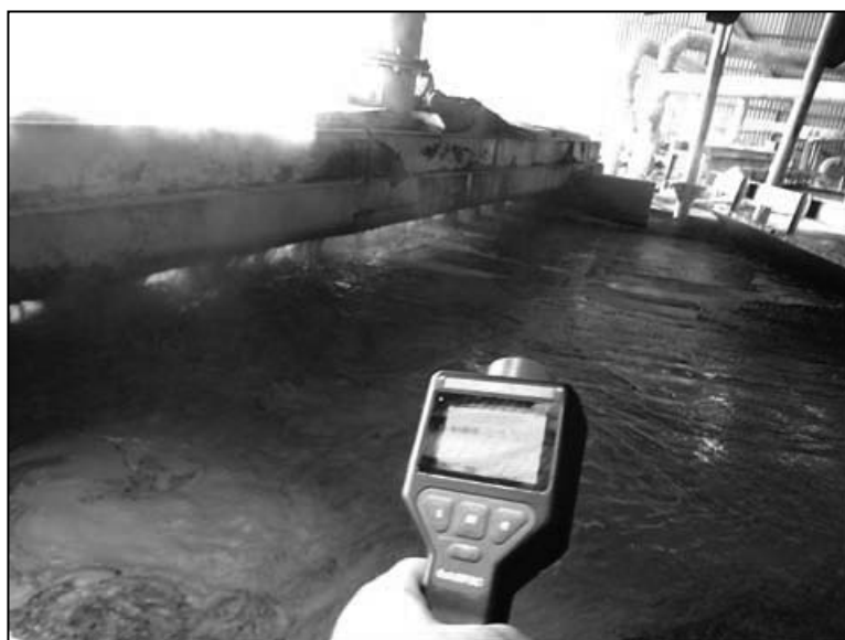
Figura 1. Monitorização da dose de radiação junto da filtração do ácido fosfórico.
