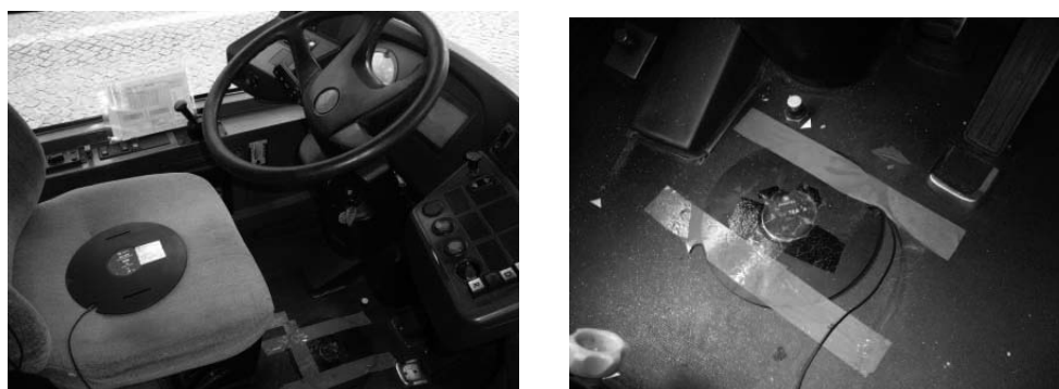
Figura 1- Acelerómetro utilizado para medição das VCI no assento e no piso, respetivamente.
