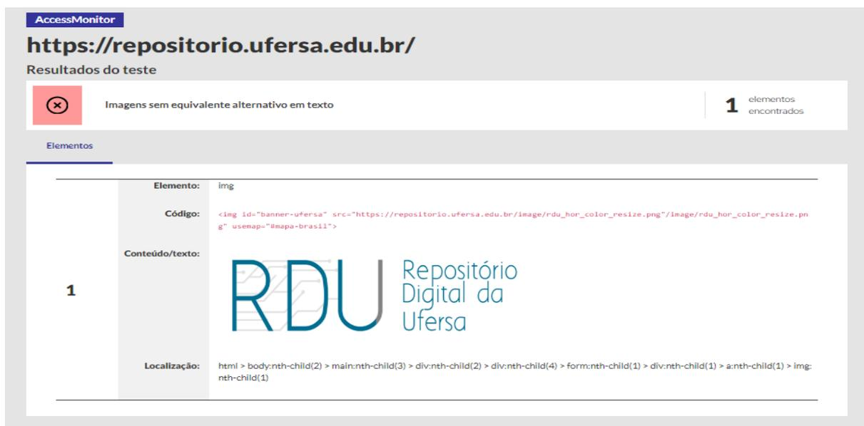
**Figura 20** - Falha do Critério de Sucesso 1.1.1 no RI-UFERSA
