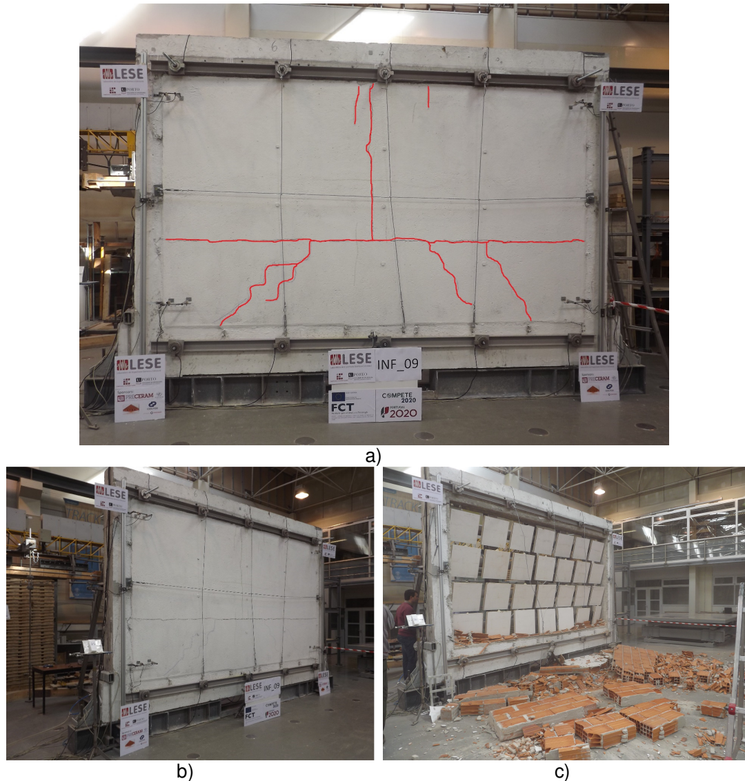
Fig. 6 – Parede não reforçada Inf_09: Danos observados a) Padrão de Fissuração; b) Vista lateral pré-colapso; c) vista lateral pós colapso.
