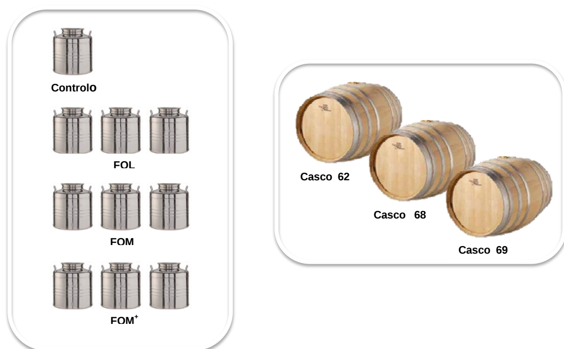
Figura 28 – Cubas de inox com vinho touriga nacional em contato com aduelas de madeira, sujeitas a diferentes queimas; e barricas de madeira, de carvalho francês com diferentes tratamentos térmicos, com o mesmo vinho touriga nacional.
