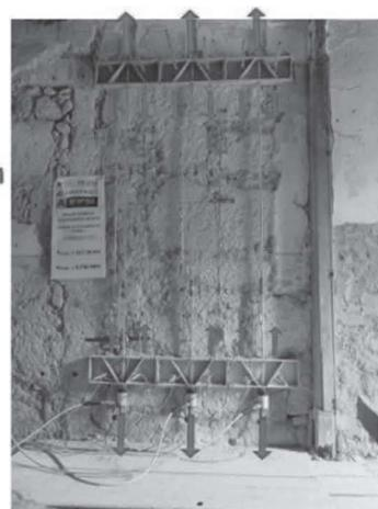
Figura 3. Zona comprimida pelo tensionamento dos varões verticais [1]
