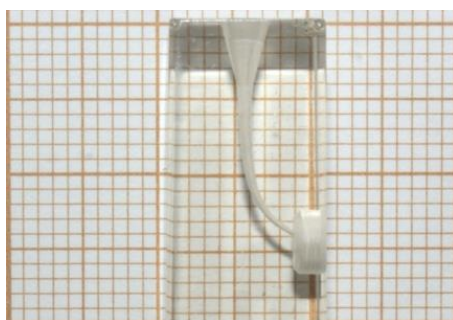
Figura 3 – Fotografia representativa do parâmetro de avaliação, conicidade, de acordo com os critérios descritos na Tabela 1: conicidade adequada.
