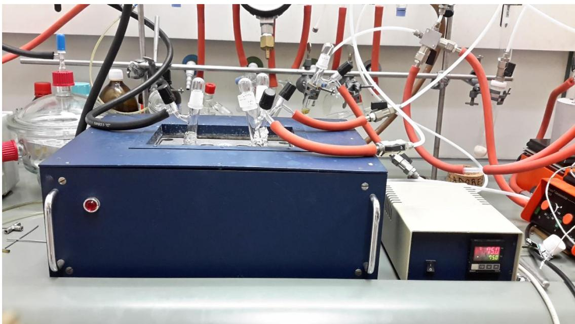
Figura 2.2 – Imagem do sistema de secagem de líquidos iônicos por vácuo.
