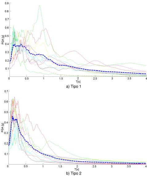
Figura 8 – Espectro elástico das acelerações do solo utilizadas
