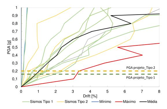
Figura 9 - Gráfico PGA vs Drift para os diferentes sismos considerados na análise da estrutura
