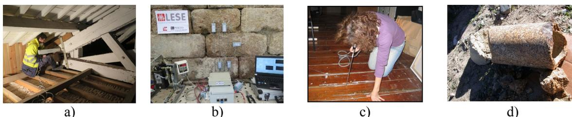
Figura 5. Ensaios *in situ*: a) Resistograph b) Macacos planos c) Videoscopia d) Extracção de carote
