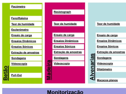
Figura 4. Listagem de ensaios não destrutivos e semi-destrutivos e abrangência da monitorização.
