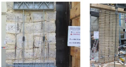
Figura 7. Ensaios em paredes de granito e de tabique em laboratório.
