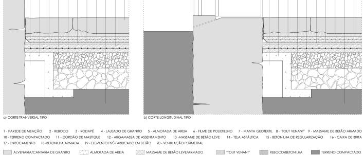
ARGAMASSA DE ASSENTAMENTO 😭 CAIXA DE BRITA 🔲 ENROCAMENTO 🛑 FILME POLIETILENO 🛑 MANTA GEOTÉXTIL 🛨 ARMADURA 🖶 TELA ASFÁLTICA
