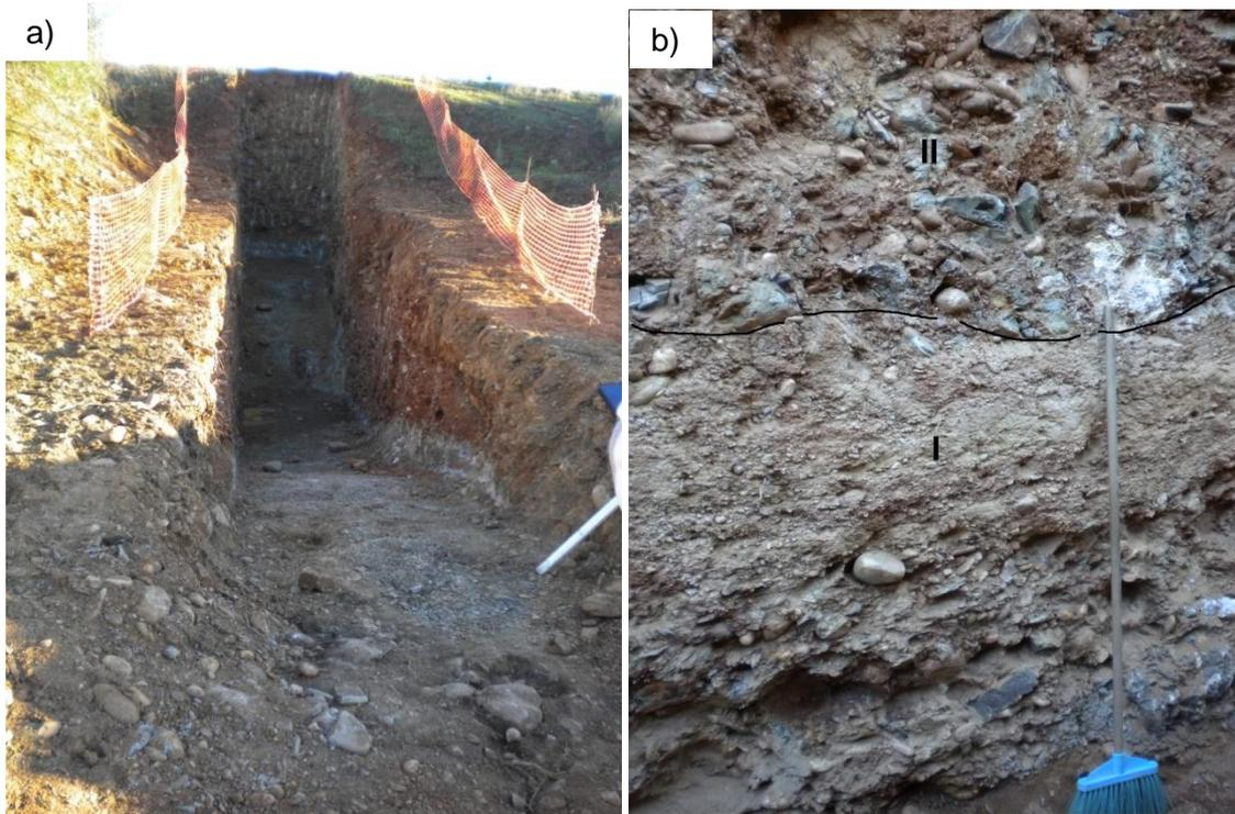
Figura 13 – a) vista frontal da trincheira efetuada no terraço fluvial em que é bem evidente o afundamento do substrato e a direcção do paleocanal; b) depósitos conglomeráticos da Unidade Estratigráfica I, em que é patente a organização dos clastos, o elevado grau de arredondamento e quase ausência de matriz. Note-se também o contato erosivo que se estabelece entre as Unidades Estratigráficas I e II.
