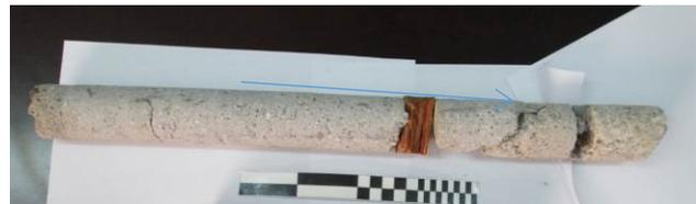
Figura 34: Perfil da carote de "Ódio" onde foi possível observar um elemento de madeira paralelo à fachada e elementos metálicos perpendiculares (2015).
