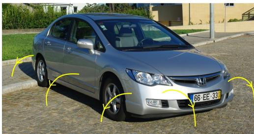
**Figura 7.6.:** Um carro é um condutor isolado. As linhas de campo são perpendiculares à superfície da carroçaria e ao chão.
