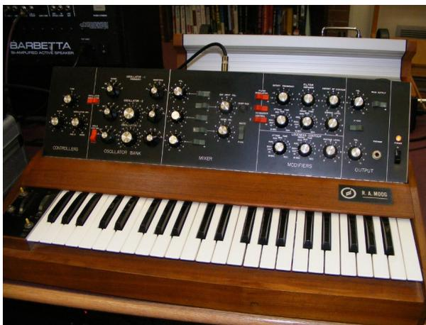
Um sintetizador é um instrumento musical baseado no processamento de sinais eléctricos. É produzida uma tensão eléctrica oscilatória que é logo processada passando por vários filtros que alteram a forma da função que representa a tensão em função do tempo. O sinal de saída é alimentado num altifalante produzindo o som desejado. A fotografia mostra um sintetizador Moog, modelo Minimoog, de 1970.
