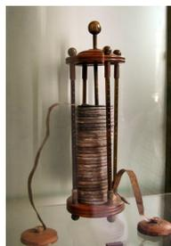
**Figura 2.2.:** Pilha de Volta.
