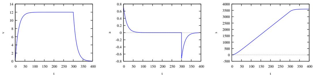
**Figura 1.6.:** Gráficos da velocidade, aceleração segundo a trajetória e distância percorrida no exemplo 1.2 (unidades SI).
