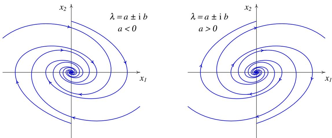
**Figura 9.7.:** Quando os valores próprios são complexos, o ponto de equilíbrio é um foco, estável (esquerda) ou instável (direita).
