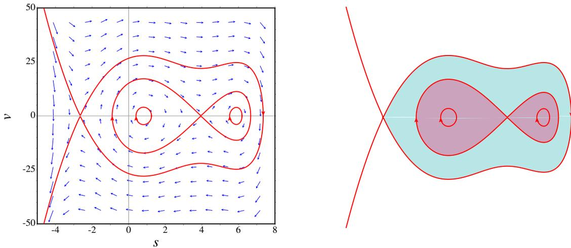
**Figura 7.6.:** Retrato de fase do exemplo 7.3; no lado direito mostram-se as regiões onde o sistema oscila.
