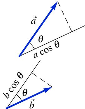
**Figura 2.8.:** Dois vetores  $\vec{a}$  e  $\vec{b}$  e o ângulo  $\theta$  entre as suas direções.
