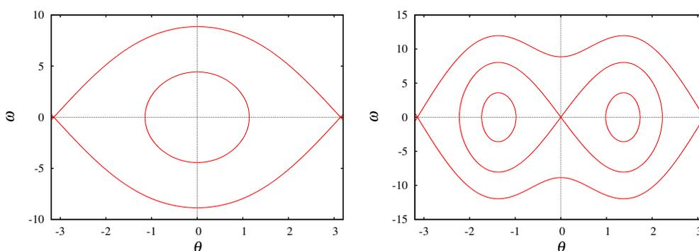
**Figura 12.4.:** Retrato de fase dum pêndulo com velocidade angular menor (lado esquerdo) e maior (lado direito) que o valor de bifurcação.
