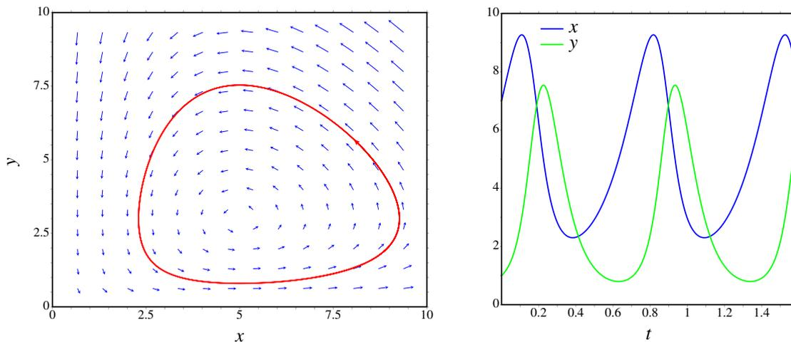
**Figura 11.7.:** Retrato de fase do modelo de Lotka-Volterra e gráfico das populações em função do tempo.
