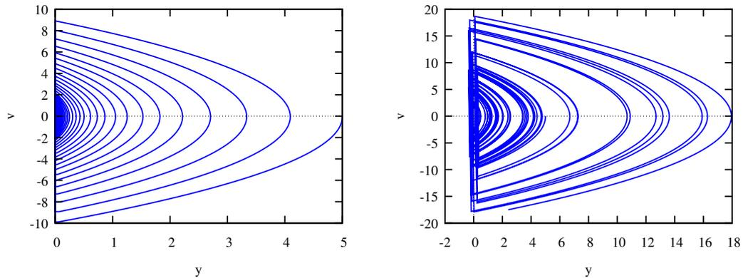
**Figura 12.5.:** Curva de evolução da bola em queda livre sobre uma mesa. No lado esquerdo quando a mesa está estática e no lado direito quando a mesa oscila.
