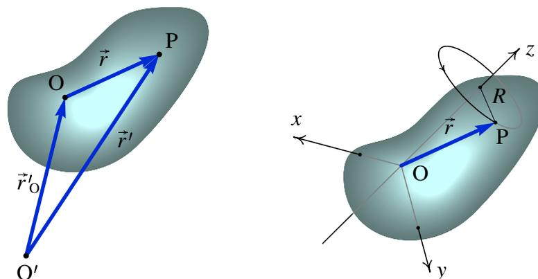
**Figura 3.7.:** Corpo rígido em movimento e referencial  $Oxyz$  que se desloca com ele.
