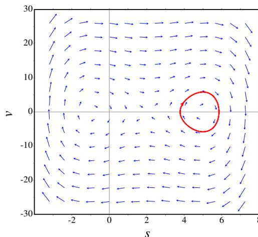
**Figura 7.3.:** Campo de direções do exemplo 7.1 e curva de evolução do sistema.
