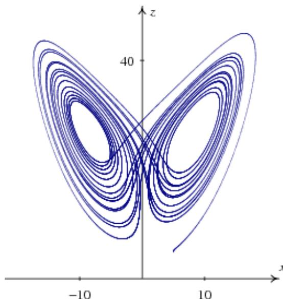
**Figura 12.8.:** Curva de evolução caótica do sistema de Lorenz, projetada no plano  $xz$ . Os parâmetros são os mesmos da figura 12.7, com  $x(0) = 5$ .
