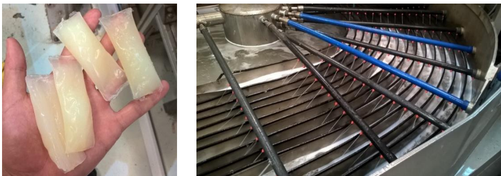
Figura 3-6: Small pillows e respetivo circuito de arrefecimento.
