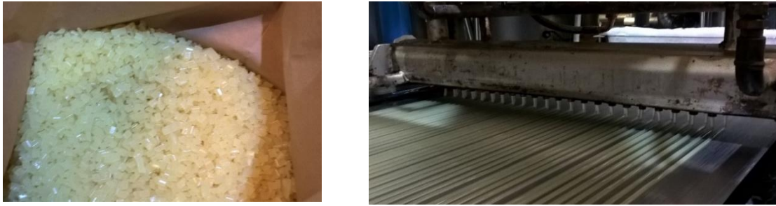
Figura 3-7: Cola em pastilha respetivo processo de extrusão para posterior corte
