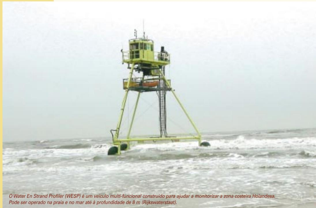
O Water En Strand Profiler (WESP) é um veículo multi-funcional construído para ajudar a monitorizar a zona costeira Holandesa. Pode ser operado na praia e no mar até à profundidade de 8 m (Rijkswaterstaat).
