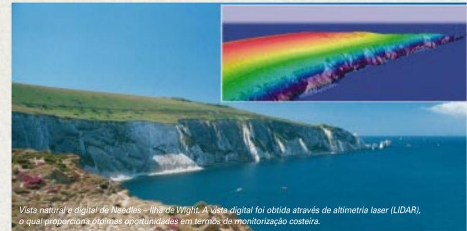
Vista natural e digital de Needles – Ilha de Wight. A vista digital foi obtida através de altimetria laser (LIDAR), o qual proporciona óptimas oportunidades em termos de monitorização costeira.
