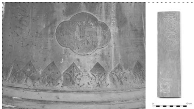
Figura 9 – Pormenor de rendilha como elemento decorativo num sino da Igreja paroquial de Ucanha, Tarouca, fundido em 1927 por Adriano Pinto Loureiro, da fundição da Granja Nova, e respectivo carimbo em madeira utilizado na concepção do seu positivo em cera (Fotografias de Luís Sebastian).
