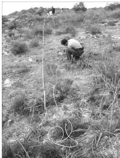
foto número 2: colocación de una línea de electrodos.
