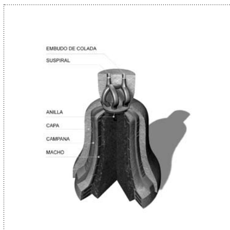
Figura 5 - Partes del molde de una campana (J. Martínez Cámara)
