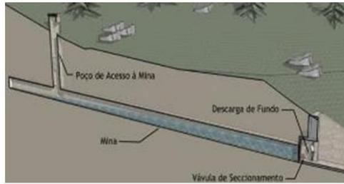
Fig. 1. a) Localização geográfica das captações das Eirinhas; b) esquema de funcionamento da captação Eirinhas nº 2 (adaptado de Sousa, 2011)
