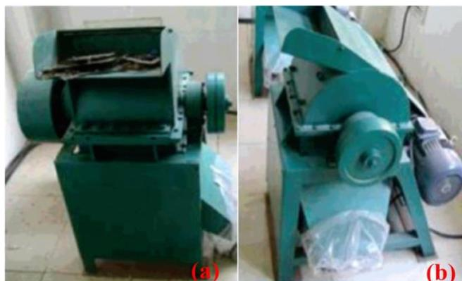
Figura 2.5- Equipamentos de tratamento físico de PCI: (a) máquina de corte; (b) moinho de martelo (Huang *et al.*, 2009)
