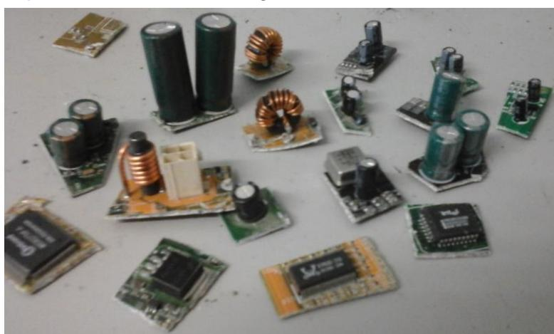
**Figura 3.4- Estado final das PCI depois do desmantelamento manual**
