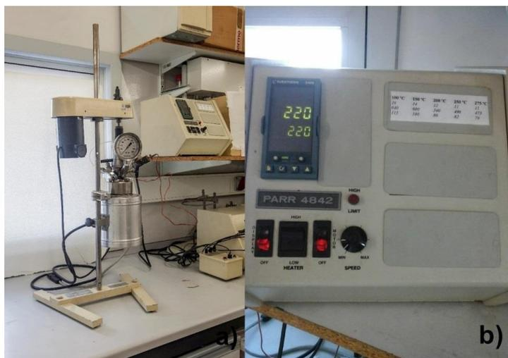
Figura 3.6- a) Reator utilizado nos ensaios; b) Painel de controlo do reator
