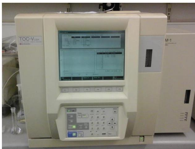
Figura 3.9- Equipamento utilizado na medição do COT
