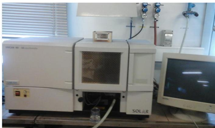
**Figura 3.8- Espectrofotômetro de Absorção Atômica de Chama utilizado na quantificação dos metais**
