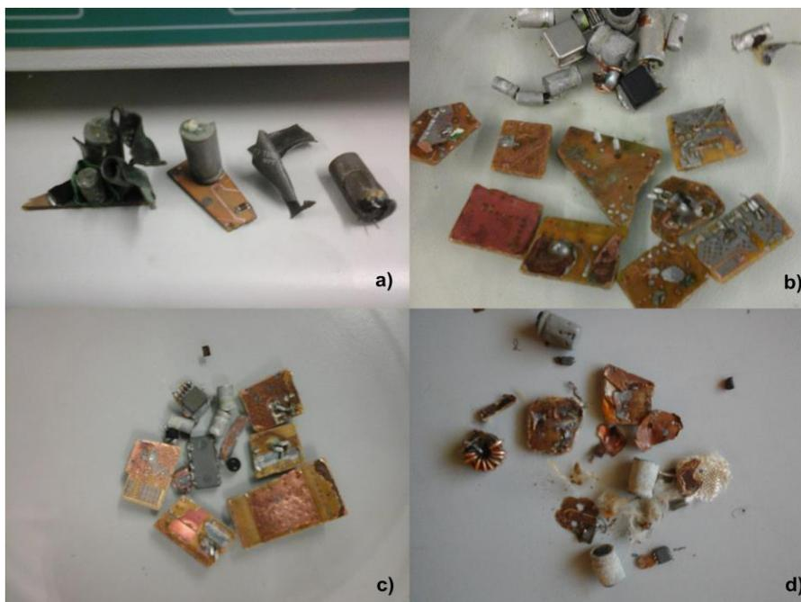
**Figura 4.4- a) PCI do ensaio a 220 °C à saída do reator; b) PCI do ensaio a 240 °C após agitação; c) PCI do ensaio a 260 °C após agitação; d) PCI do ensaio a 280 °C após agitação**
