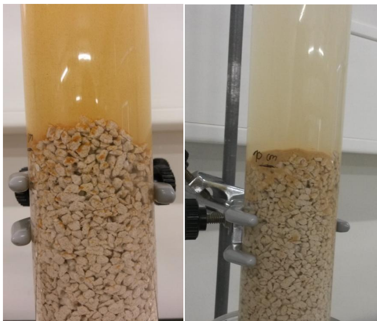
Figura 25 - Precipitados Retidos na camada de calcário no início (t=0 horas) e fim (t=72 horas) do E3, respetivamente.
