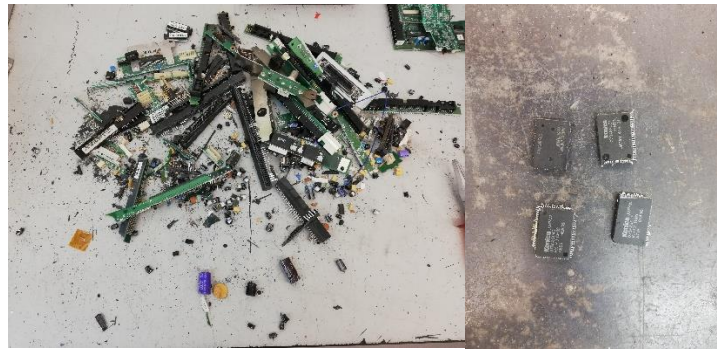
Figura 3.1- Componentes retirados das PCI (microships, condensadores, bobinas, etc.).
