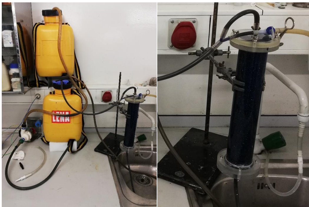
Figura 3.6- Esquema do sistema de lixiviação (esquerda) e coluna de lixiviação (direita).
