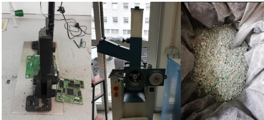
Figura 3.2- Equipamentos utilizados para desmantelamento e fragmentação das PCI (Guilhotina, Fragmentador, amostra fragmentada).
