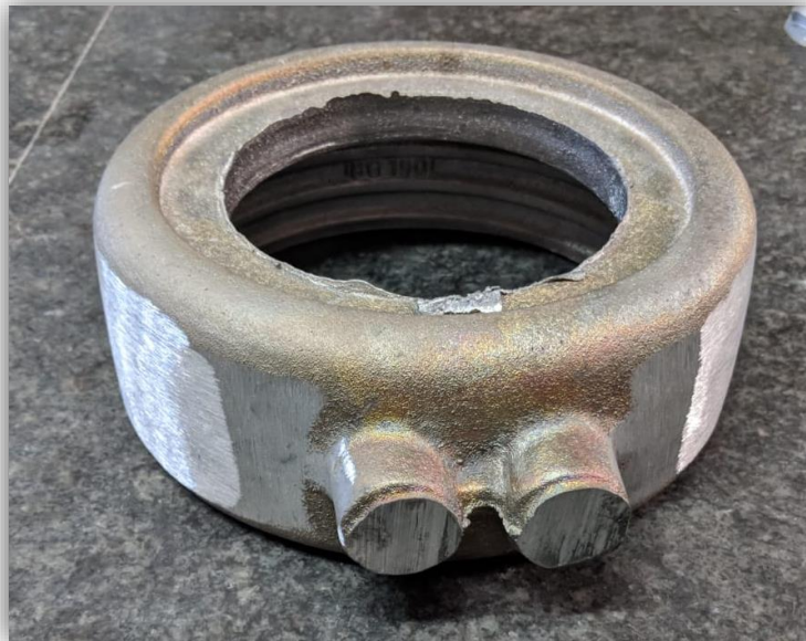
Figura 38: Peça produzida recorrendo ao sistema de gitagem e alimentação original.
