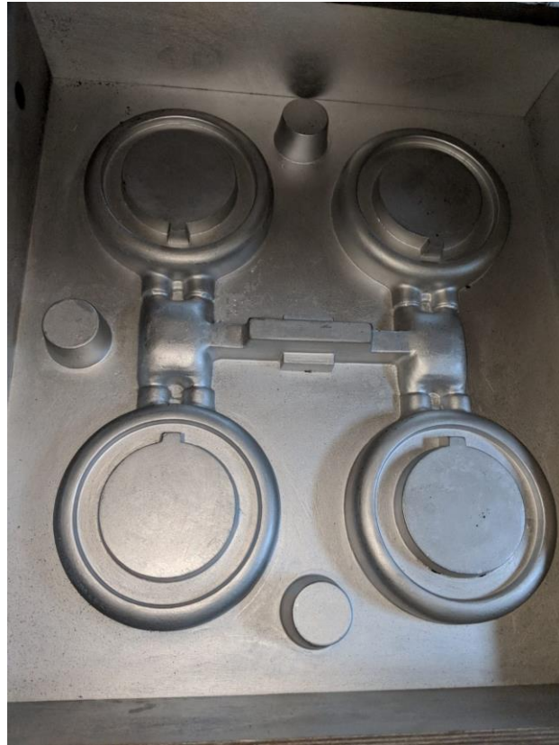
Figura 16: Placa molde inferior original da peça 1, mostrando apenas 2 alimentadores para as 4 peças.
