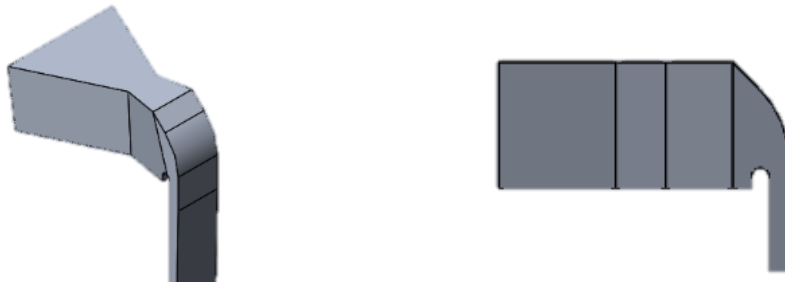
Figura 21: Bacia de enchimento utilizada na peça 1.
