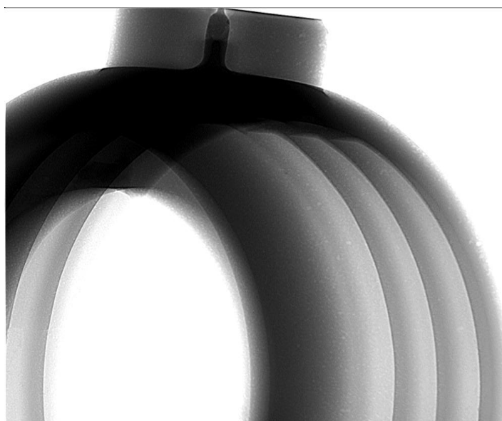
Figura 37: Imagem de raio-x obtida para a peça produzida com o sistema de gitagem e alimentação original.
