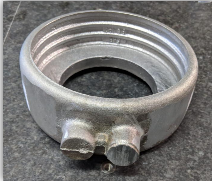
Figura 39: Peça produzida utilizando o sistema de gitagem e alimentação novo, apresentando uma cor cinzenta brilhante.
