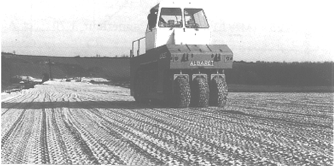
Compactador de pneus: P3 (carga por roda > 60 kN)
