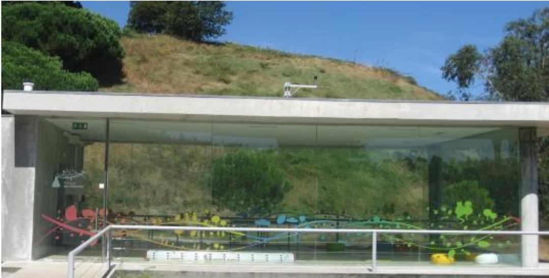
Figura 14 – Sistema de monitorização de ruído no telhado de um dos edifícios do Parque da Ciência em Matosinhos, adaptado de [73].
