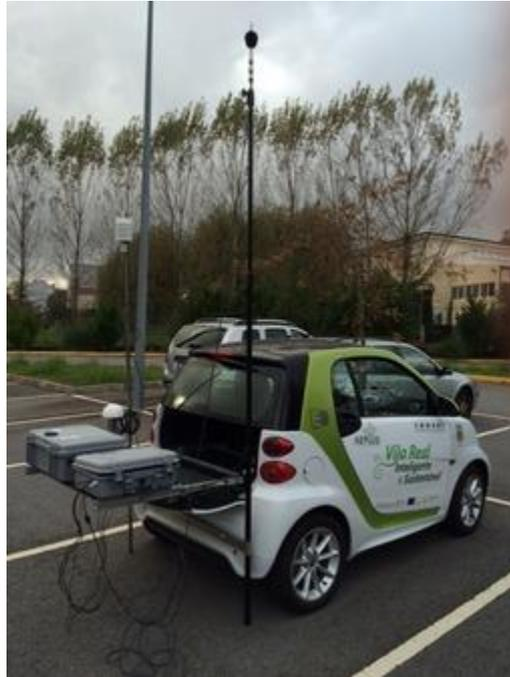
Figura 13 – Sistema de monitorização de ruído acoplado a um veículo em Vila Real, adaptado de [71].
