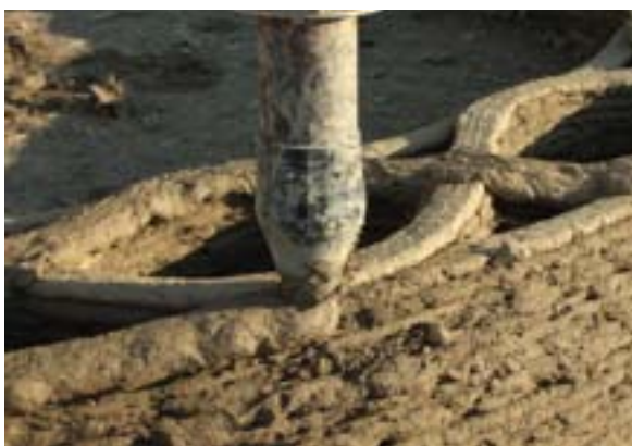
Figuras 16 e 17 - Impressão em argila, da empresa WASP. Fontes: BigDeltaWASP 12m (s/d.).
