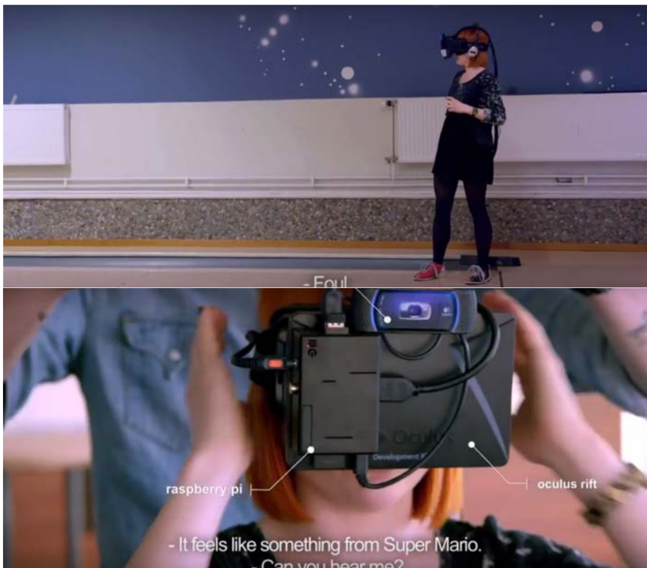
Figuras 3 y 4: Experimento Living with Lag. En este experimento, llevado a cabo con una webcam, una Raspberry Pi y un HMD Oculus Rift DK1, se induce un retraso de pocos segundos en la señal de recepción (con respecto al entorno físico) en las personas que se encuentran usando el dispositivo, lo que produce un impedimento evidente en las actividades que desarrollan en la vida cotidiana. El experimento forma parte de una campaña de ume.net, una empresa de telecomunicaciones y energía sueca, para poner de relieve las perturbaciones que provocaría, a su vez, una señal de internet lenta.
