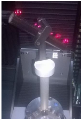
Figura 30 - Padrão montado com o seu suporte no compartimento da máquina de tomografia.
