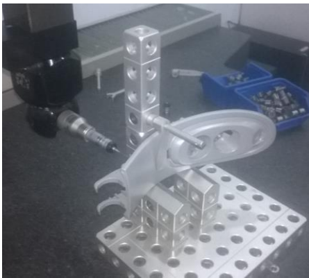
Figura 27 - Peça de alumínio fixa no gabari construído com o kit Alufix.
