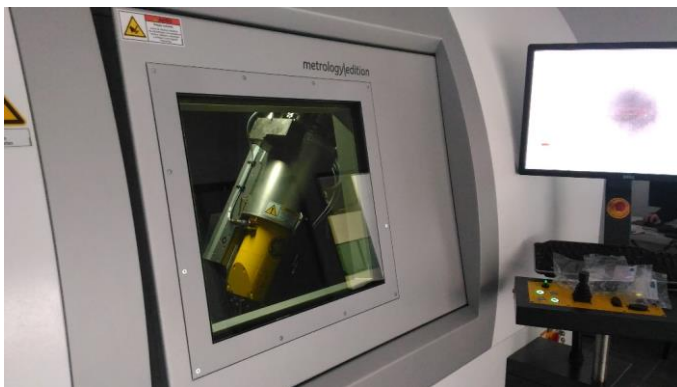
Figura 11 - Fotografia da máquina de CT Phoenix v|tome|x m. (Cortesia da Micronsense)
