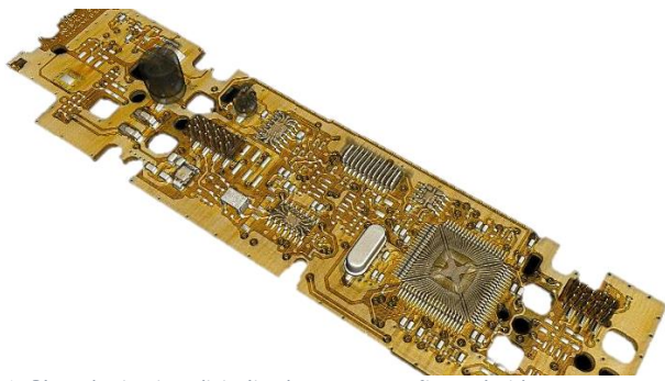
Figura 14 - Placa de circuitos digitalizada por tomografia e colorida com recurso ao software VGStudio Max. (Cortesia da Micronsense)
