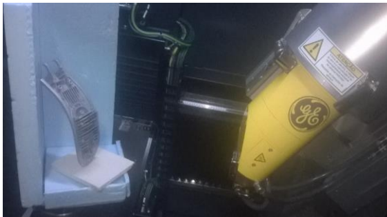
Figura 18 - Posicionamento da peça de alumínio dentro da máquina de tomografia.
