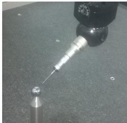
Figura 28 - Calibração de um dos ângulos utilizados durante a medição das peças.
