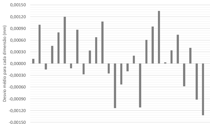
Figura 34 - Gráfico com a diferença média entre as três medições de cada dimensão.
