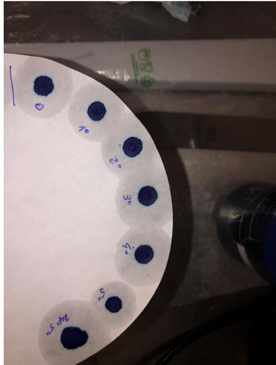
Figura 34: Aspeto das diversas gotas sobre o papel de filtro no ensaio de determinação do Azul de Metileno.
