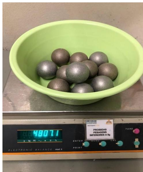
Figura 31: Esferas de aço (11) utilizadas como carga abrasiva.
