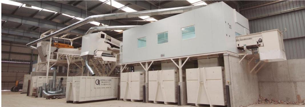
Figura 16: Ilustração de uma Estação de Triagem Manual aplicável no âmbito do presente estudo <sup>10</sup>.
