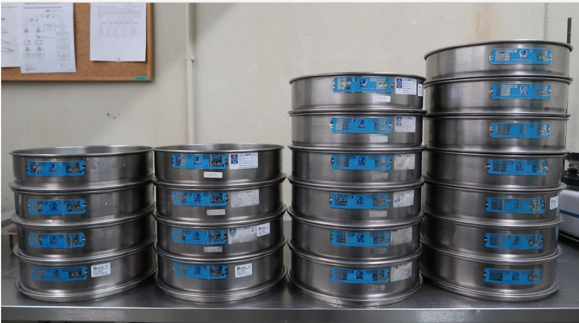
**Figura 28: Peneiros utilizados na realização do ensaio da Análise Granulométrica.**
