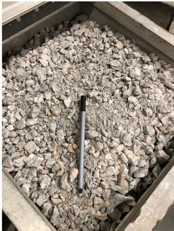
**Figura 27: Material Reciclado após secagem no LMC.**
