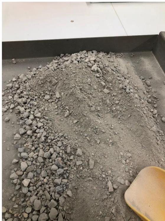
Figura 32: Aspeto visual da amostra após o Ensaio de Los Angeles.
