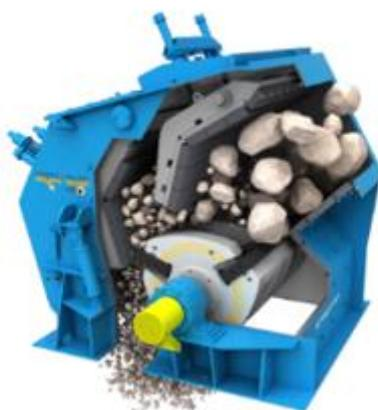
Figura 23: Imagem ilustrativa de um britador de impacto <sup>15</sup>.
