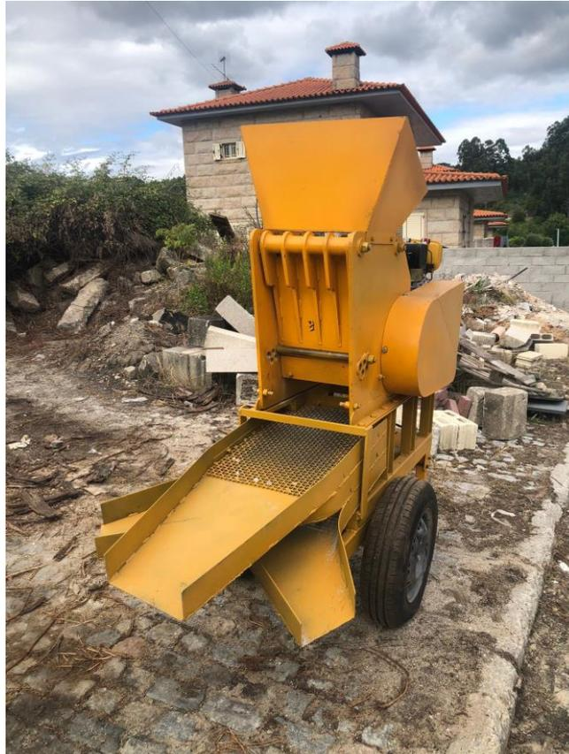
**Figura 19: Britador de mandíbulas móvel utilizado pela empresa.**
