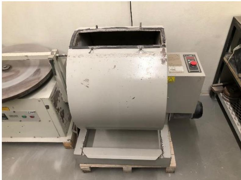
Figura 30: Equipamento Los Angeles do Laboratório de Materiais de Construção.
