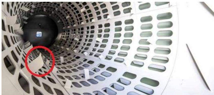
Figura 14: Exemplo de crivo rotativo evidenciando dentes/lâminas na sua superfície <sup>8</sup>.
