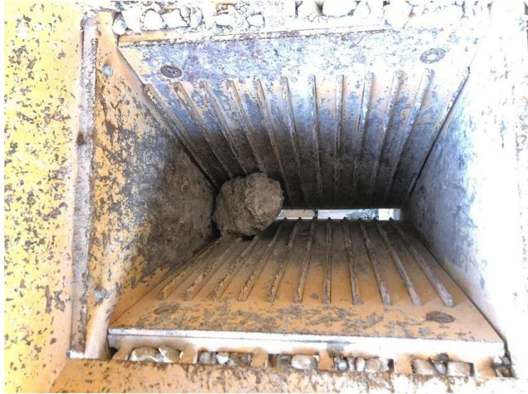
**Figura 17: Exemplo de um engaiolamento na boca de entrada de um britador de mandíbulas da empresa.**
